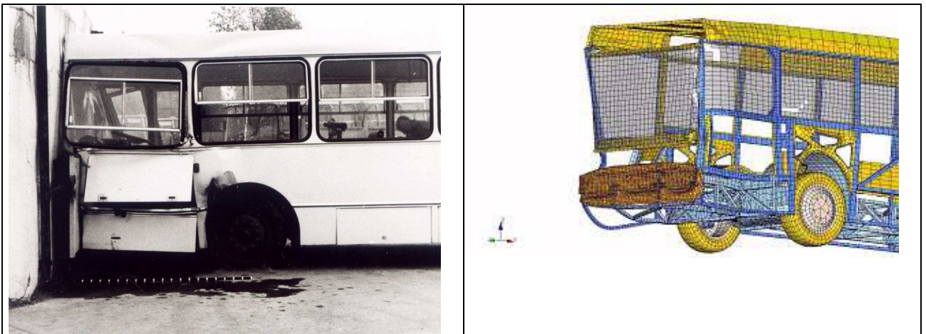
7. ábra: A 10 tonnás IK 415 prototípusának kísérleti ütközéses vizsgálata és számítógépes szimulációja. (Az IK 411 autóbusz vázszerkezetileg pontosan megegyezik a Budapest útjain jelenleg is futó IK 415 jelű autóbusszal.)
