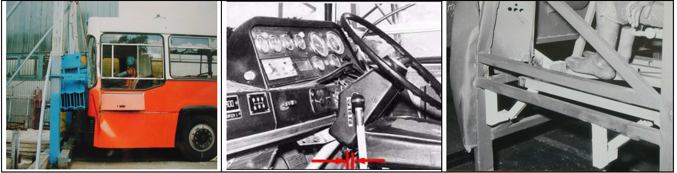
6. ábra: Autóbusz-homlokkal ütközéses vizsgálata 4 tonnás ingás ütőművel. Frontális ütközés esetén, rosszul kialakított vezetőtérben a kormánykerék a vezető hasába nyomódhat; a vezetőülés-kormányoszlop megfelelő távolságának biztosítására szolgál a hátrafelé billenő biztonsági dobogó
