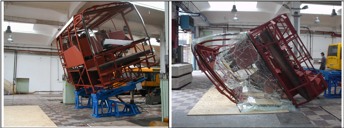
4. ábra: A komplett busz borítóvizsgálata helyett az ellenőrzés elvégezhető a lényeges szerkezeti elemeket tartalmazó modellbuszon is. (Az ábrán egy 12 m-es autóbusz 5 m-esre rövidített modelljének borítóvizsgálata látható.)
