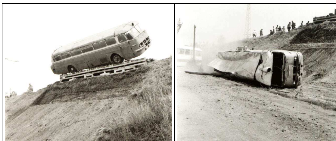
2. ábra: Az első magyar lejtős borítóvizsgálatok egyike – a legendás IK 55 típusú autóbusz 1972-es felépítmény vizsgálata
