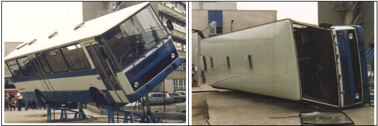
3. ábra: Az 1986-ban hatályba lépett EGB 66 számú előírás azt írja elő, hogy a komplett önsúlyos autóbust 800 mm magasról betonfelületre kell lebillenteni
