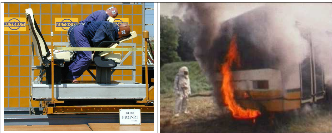
8. ábra: Hárompontos kettős autóbuszülés vázszilárdságának és szimulációja lekötésének vizsgálata 30 km/h sebességű, dinamikus vizsgálattal, Hybrid típusú bábuk alkalmazásával.
